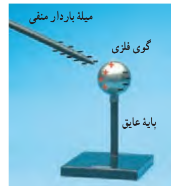
شکل ۱-۳۰ نزدیک کردن میله باردار منفی به گوی فلزی خنثایی که روی پایه عایقی قرار گرفته است، موجب ایجاد بارهای القایی مثبت و منفی در دو طرف گوی فلزی می‌شود.
