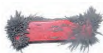
شکل ۳-۳ در آهنربا، دو ناحیه وجود دارد که خاصیت مغناطیسی در آنجا بسیار بیشتر از قسمت‌های دیگر است.
