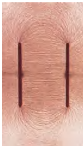
شکل ۱-۱۹ سمت گیری دانه‌ها در فضای بین دو الکتروود صفحه‌ای موازی
