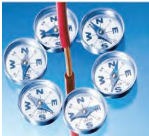
شکل ۳-۱۴ میدان مغناطیسی اطراف سیم حامل جریان را می‌توان با قرار دادن تعدادی عقربه مغناطیسی پیرامون آن نشان داد.
