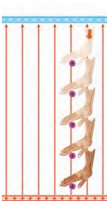
شکل ۱-۲۷ نیروی خارجی، بار +q را در خلاف جهت میدان الکتریکی جابه‌جا می‌کند.
