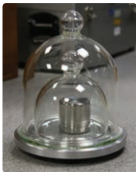
شکل ۱-۷ استاندارد ملی کیلوگرم که نسخه دقیق‌تری از استاندارد بین‌المللی سیور فرانسه است. این نمونه، در مرکز اندازه‌شناسی در سازمان ملی استاندارد ایران نگهداری می‌شود.
